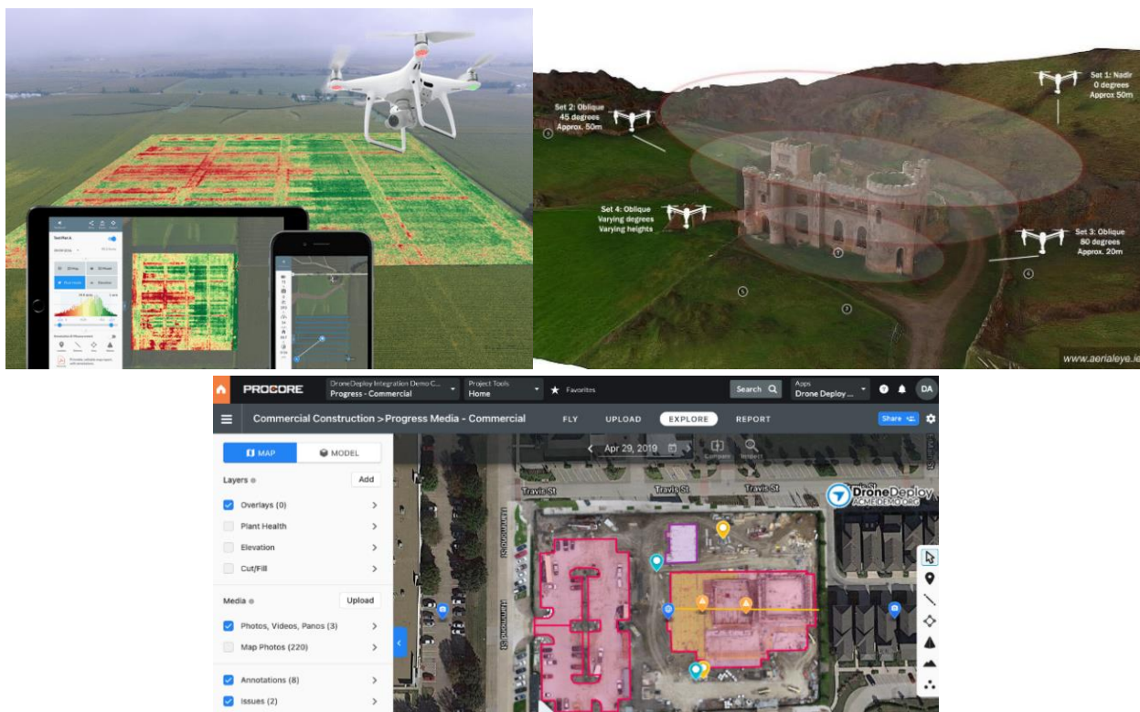
Slika 4: Primeri zaslonov aplikacij: Vmesnik za kartiranje z brezpilotnimi letalniki, pregledovalnik 3D modela, analiza napredka gradnje
